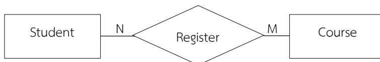
ภาพที่ 2.13 แสดงความสัมพันธ์แบบ Many to Many Relationships
